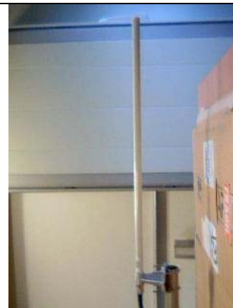
Figura 3.4 Antena omnidireccional de 10 dBi
