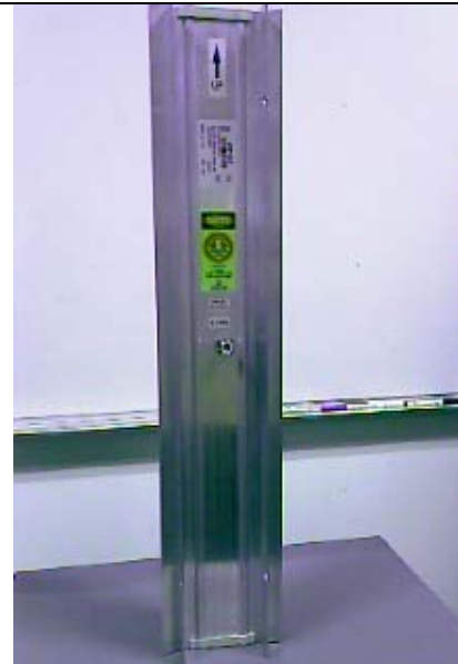
Figura 3.6 Antena sectorial de 14.5 dBi. Vista trasera
